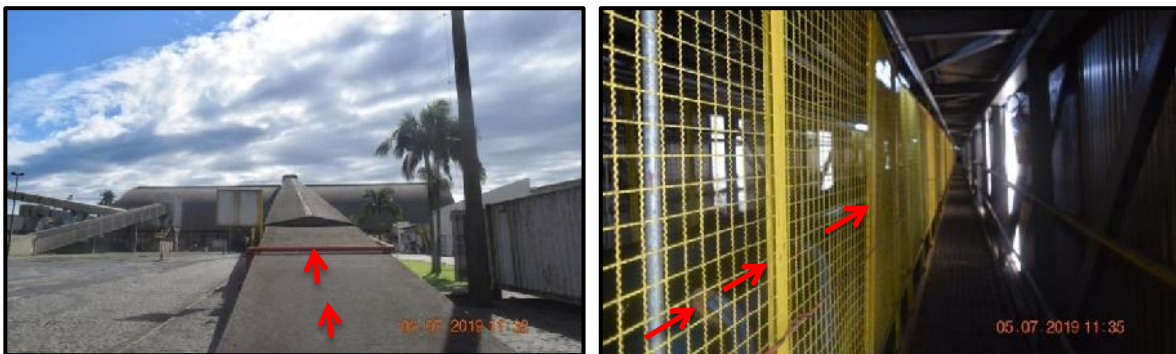
Figura 8 – Transporte da carga por correias transportadoras até os armazéns.
